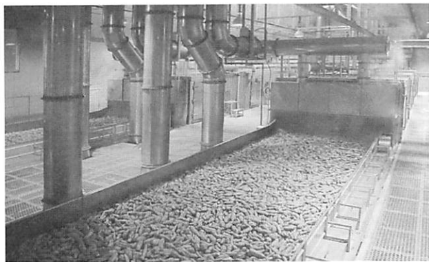
芋を載せたコンベアが機械の中をゆっくりと移動する間に蒸し・冷却を行います。
