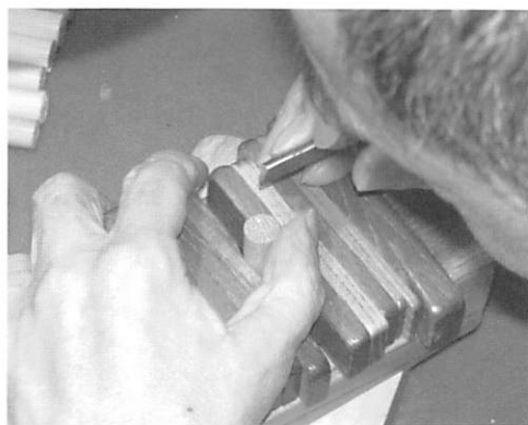
印鑑製作 木口部仕上げの作業
