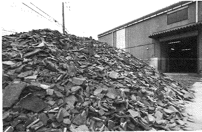
新規リサイクル事業(瓦をチップ状にして道路舗装に利用する)
